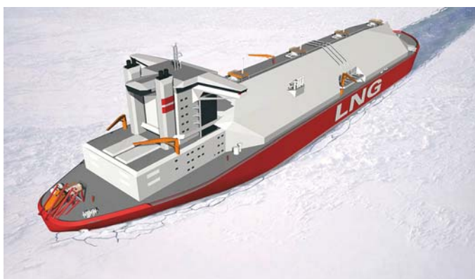
Aker Arctic 206,000m³ IHS design for Arctic LNG transports from 2006.
